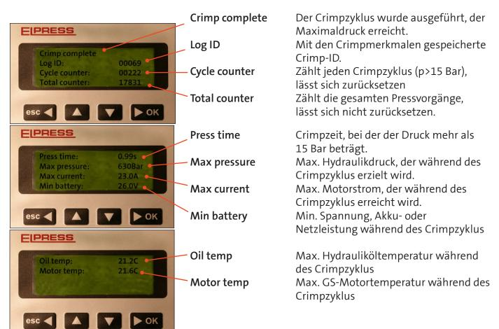
Befindet sich einer der o.g. Parameter wie z.B. Presszeit, Druck, Stromstärke, Spannung, Öl- oder Motortemperatur außerhalb der voreingestellten Grenzen, wird eine Fehlermitteilung zum aktuellen Problem angezeigt. Wurde ein Crimpzyklus gestartet, aber nicht innerhalb von 60 s abgeschlossen, wird die Überschreitung des Zeitlimits in Form einer Meldung auf dem Display angezeigt. Alle Fehlermitteilungen läßt sich im Menü für "Active faults" zurücksetzen.
