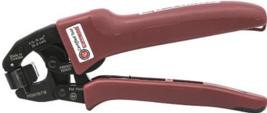
Die PEB0110T18 ist ein neues Werkzeug zum Verpressen von Aderendhülsen von bis zu 18 mm Länge in einem Crimpvorgang. Das Presswerkzeug ist selbsteinstellend und somit kann hohe Qualität gewährleistet werden. Dank der frontalen Einführung ist das Werkzeug benutzerfreundlich und auf beengtem Raum praktisch einsetzbar. Das Presswerkzeug wurde mit 50 000 Pressungen ohne Kalibrierung getestet und ist somit „life-time-calibrated“.
