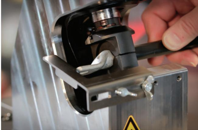
Der TS1300 ist ein Tischständer, der mit den Pressköpfen DV1300C2 und V1300C2-AL verwendet werden kann. Der Tischständer ist für Bediener konzipiert, die den C2-Presskopf mit hoher Frequenz verwenden. Mit dem Tischständer erhalten Sie eine stabile, sichere und einfache Verwendung des C2-Presskopfs.
